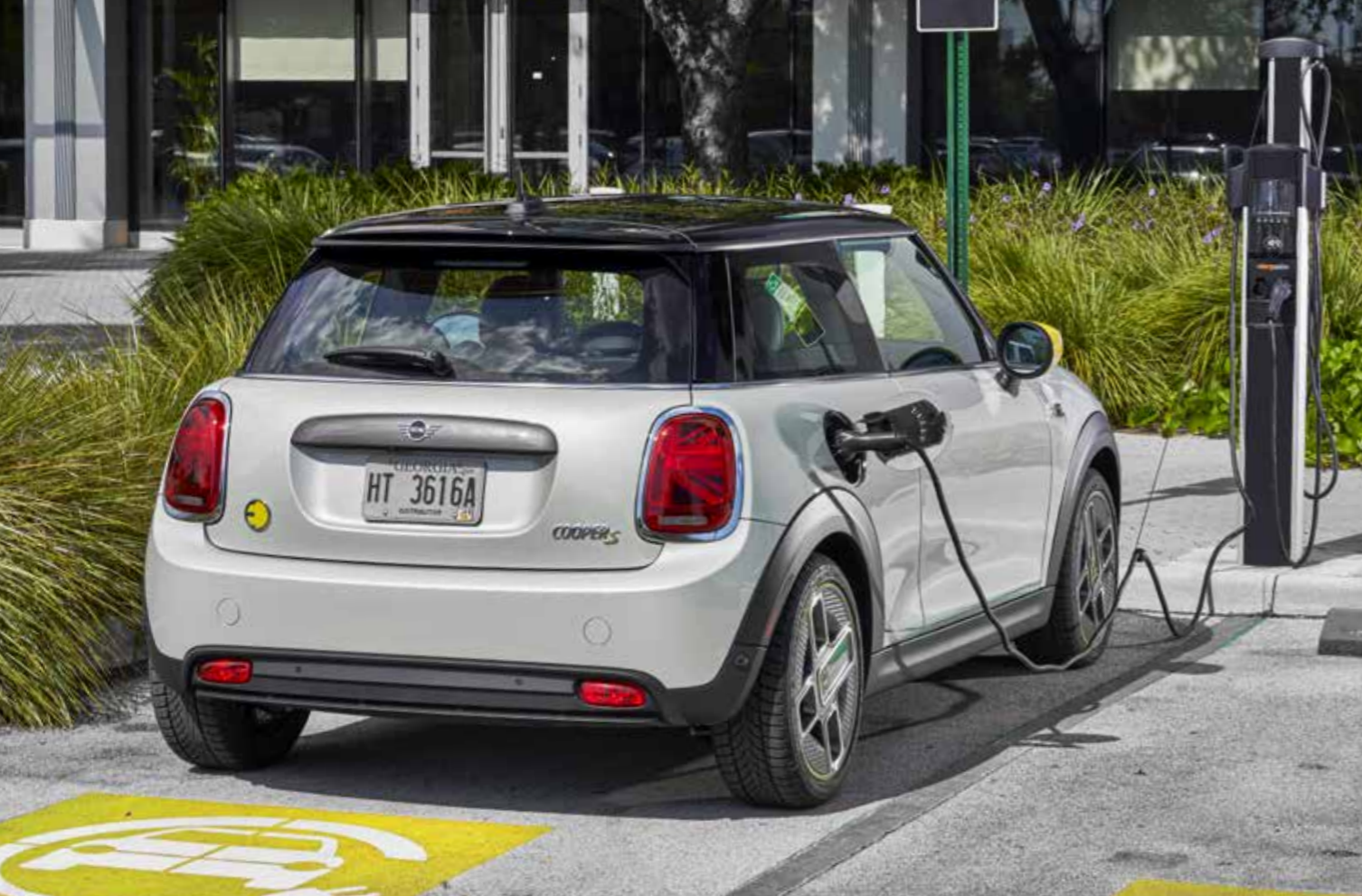
CCS-Schnellladen mit 50 kW ist ebenso möglich wie über Typ 2 mit 11 kW an der Wallbox
