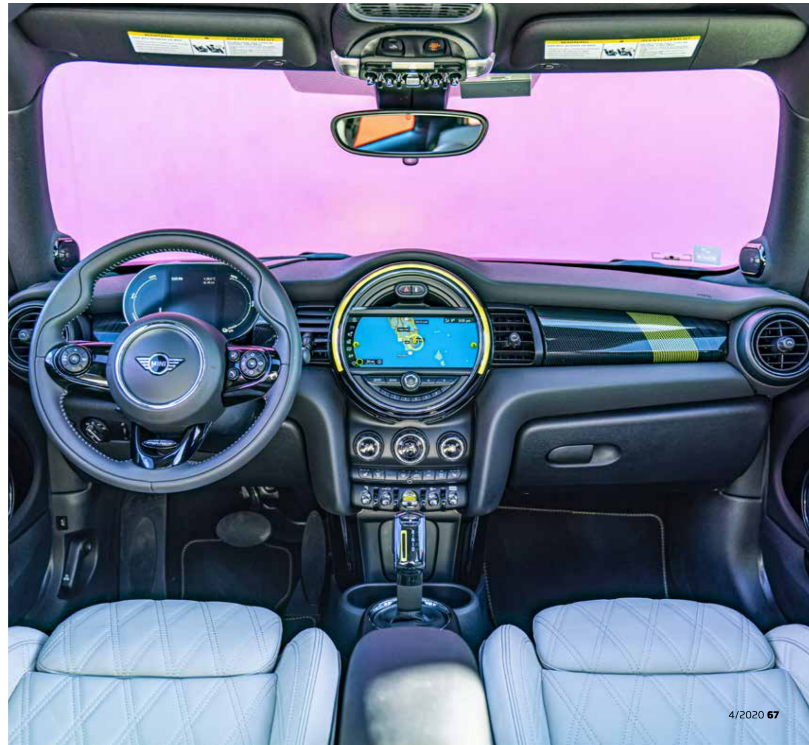
Statt analoger Instrumente bietet der SE ein übersichtliches TFT-Display, leistet sich allerdings noch eine richtige Nadel auf der linken Seite, um die abgerufene Kraft anzuzeigen. Da die Batterie sich passgenau an die Karosserie schmiegt, die knapp zwei Zentimeter höher liegt, bleibt sowohl der Platz im Fond als auch der Gepäckraum (211 bis 731 Liter) erhalten. Die Verarbeitung ist solide, Navigation und Zweizonenklima samt Wärmepumpe sind Serie
