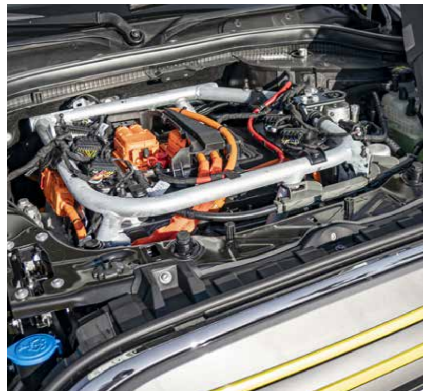
Unter einer Abdeckung steckt der entkoppelte Hilfsrahmen mit Elektronik und Antrieb
