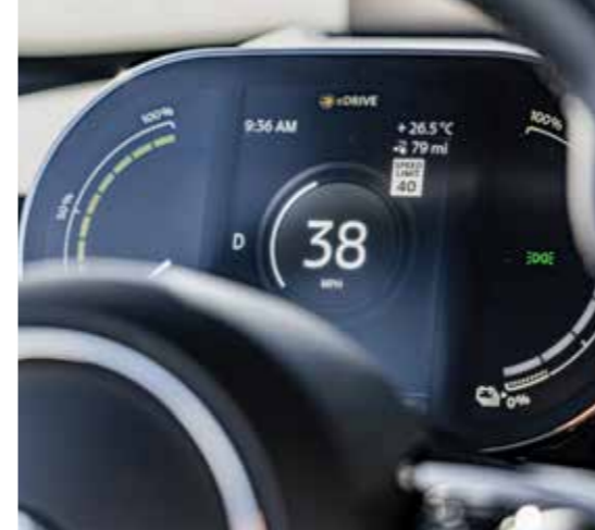
Statt analoger Instrumente bietet der SE ein übersichtliches TFT-Display, leistet sich allerdings noch eine richtige Nadel auf der linken Seite, um die abgerufene Kraft anzuzeigen. Da die Batterie sich passgenau an die Karosserie schmiegt, die knapp zwei Zentimeter höher liegt, bleibt sowohl der Platz im Fond als auch der Gepäckraum (211 bis 731 Liter) erhalten. Die Verarbeitung ist solide, Navigation und Zweizonenklima samt Wärmepumpe sind Serie
